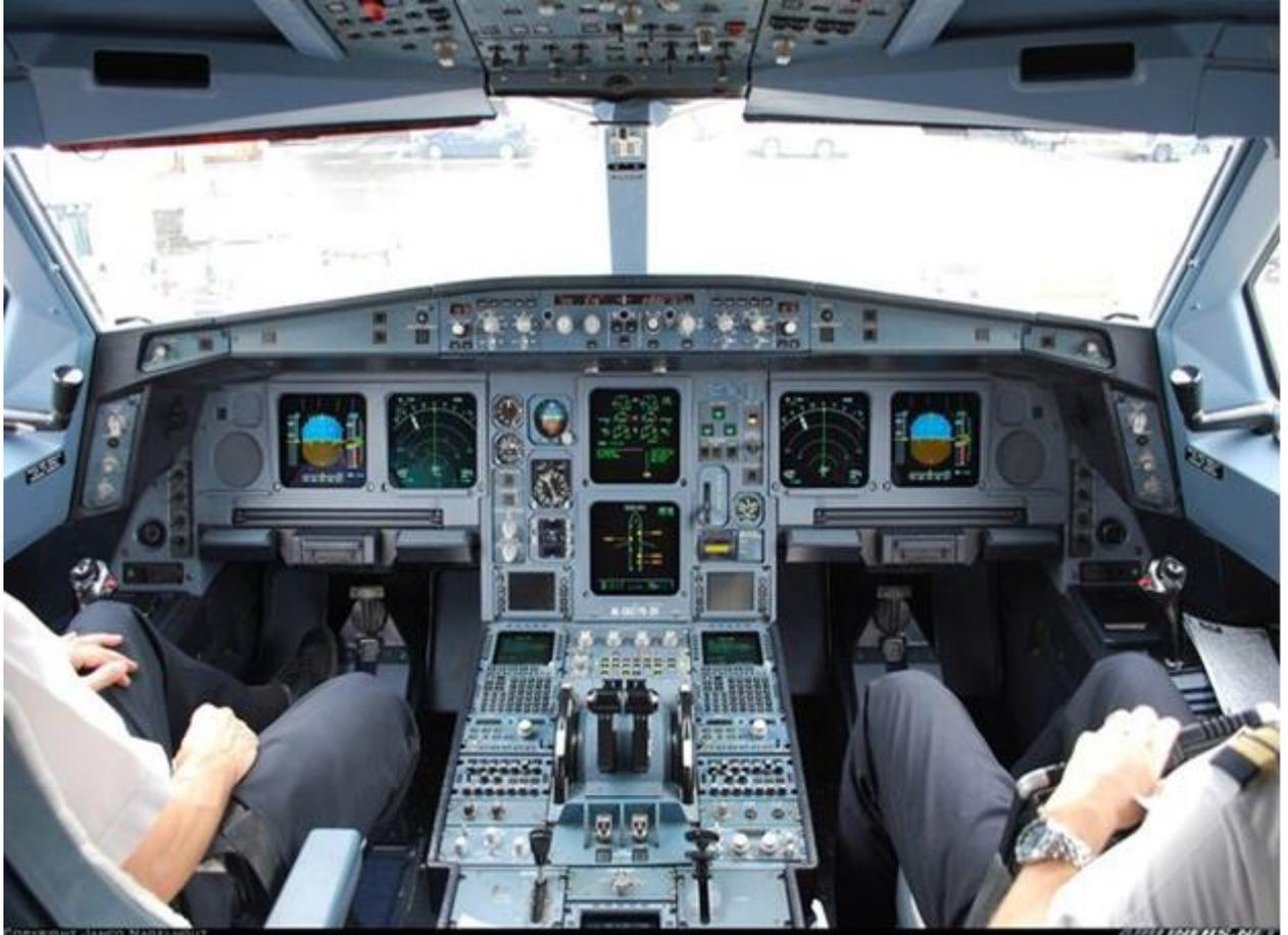
Lo más llamativo de estas cabinas es que en la del A-330 no existe el comando de vuelo (volante) y aparece a los costados de ambos pilotos un sidestick que en forma eléctrica/electrónica, cumple las funciones del comando de vuelo.
