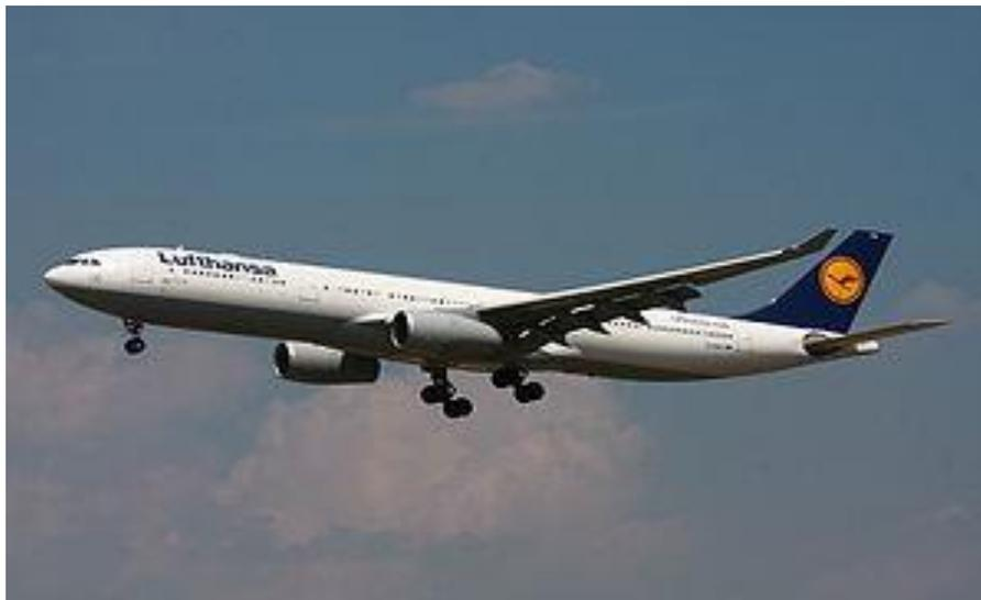
El Airbus 330 tiene una envergadura de 60 m y un largo de 50 m, con un alcance de 10.500 km, un Peso Máximo de Despegue de 230 t y una capacidad de 330 pasajeros. Esta aeronave se controla por un sistema fly by wire.
